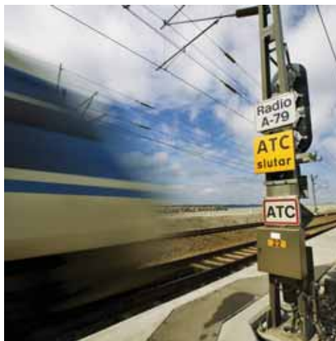
Systemgräns för automatiskt skifte mellan danskt och svenskt järnvägssystem.
