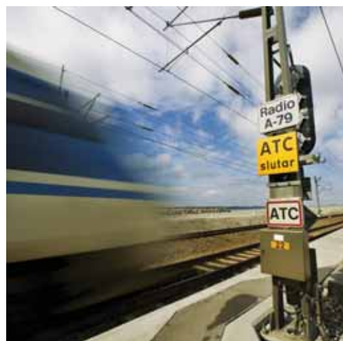
Systemgrænsen, hvor der skiftes automatisk mellem dansk og svensk jernbanesystem.
